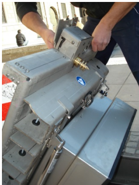
Deckel mit hydraulischer Unterstützung aufziehen bis er einrastet
