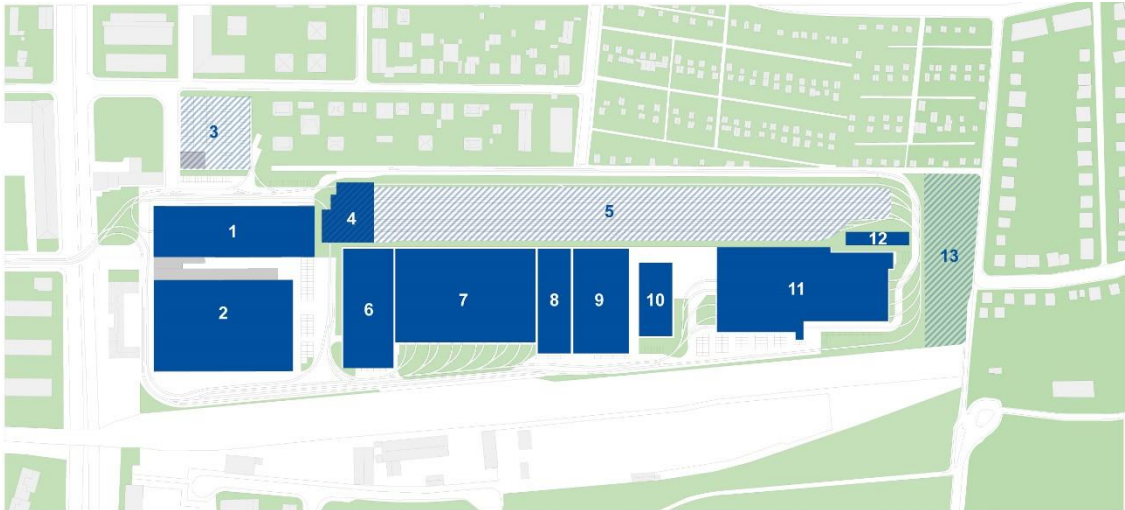
Abbildung 1 – Übersichtsplan über das Grundstück (1) MVG-Museum | (2) bestehende Hauptwerkstätte | (3) Parkplatz mit BD I Betriebsdienstgebäude 1 | (4) Schallschutzeinhausung | (5) Abstellanlage | (6) WI Drehgestellwerkstatt | (7) WI Werkstatt Instandhaltung | (8) WL Komponentenwerkstatt | (9) WL Werkstatt Logistik | (10) BD II Betriebsdienstgebäude 2 | (11) WD Werkstatt Durchlaufwartung | (12) TGW BD1 Gleichrichterwerk BD1 | (13) CEF-Fläche
